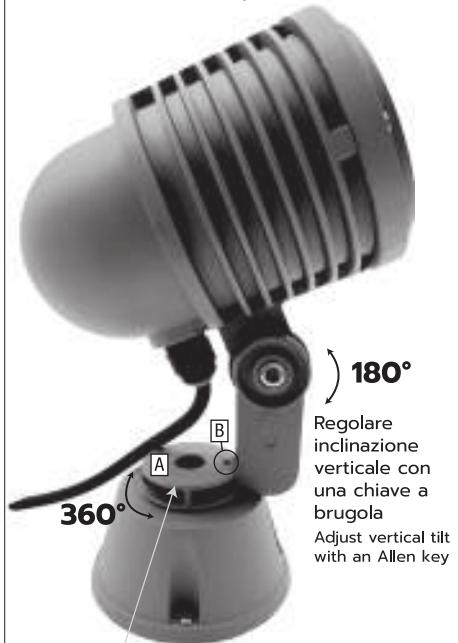
Per regolare il fascio orizzontalmente ruotare il corpo lampada (A). Una volta raggiunta la rotazione desiderata procedere al fissaggio con una chiave a brugola (B).
