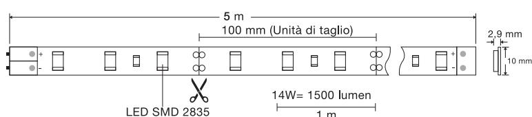
Indispensabile fissaggio su profili in alluminio per una adeguata dissipazione del calore. Da ordinare separatamente.
